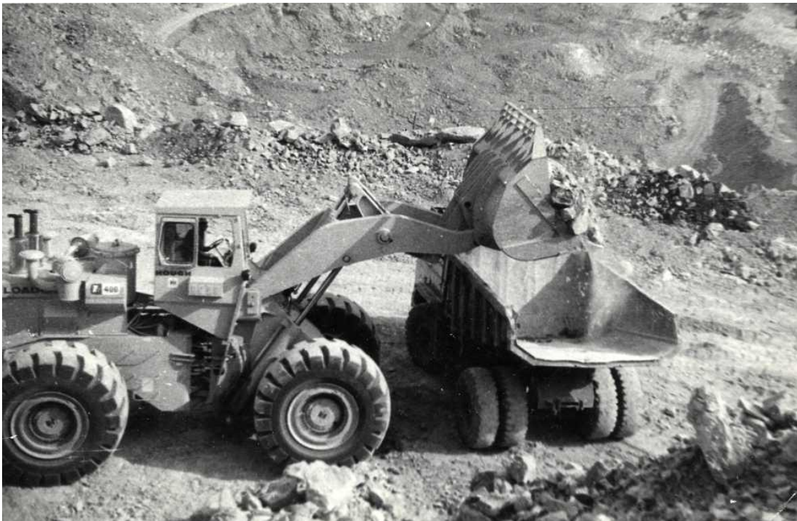
Рис. 2. Относительное положение автосамосвала и погрузчика при разгрузке ковша
